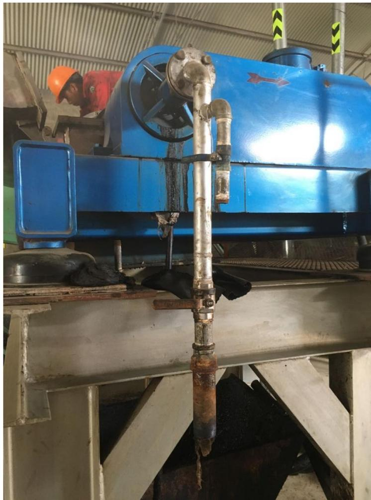
生产区地面已进行防渗处理，且地面已硬化处理，无破损现象，生产区机器法兰处有“跑、冒、滴、漏”的情况。
